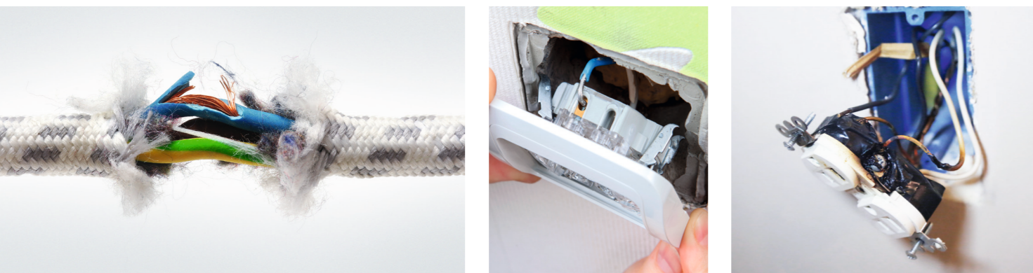
Рис. 10: Возможные причины параллельных дуговых пробоев
